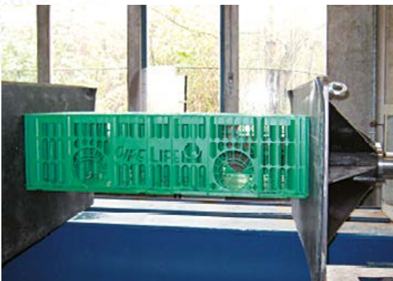
Lastwiderstandstest der Stormbox
